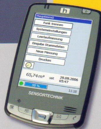
Die Kalibrierung der Anlage erfolgt mittels Nullmessung, die einmal nach der Installation der Bandwaage durchgeführt wird und nur wenige Sekunden benötigt.
